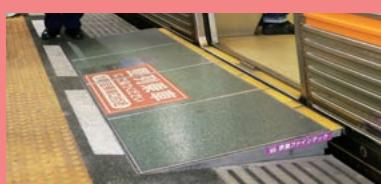
乗降時の段差が少なく、車椅子の方やご高齢の方もスムーズに乗降できる車両(低床式電車、ノンステップバス)を導入しています。
