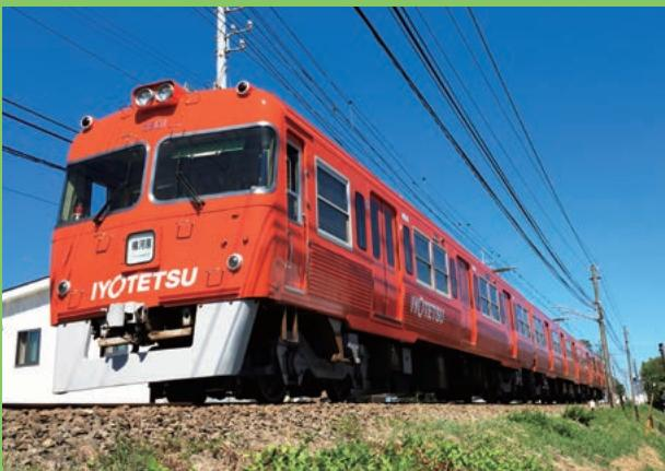
新型鉄道車両(3000系)はブレーキをかけるときに発生する電気を電線に返す回生(かいせい)ブレーキを採用しています。また、VVVFインバータ搭載により、電気の強さを自由に調節し、電気のムダを削減しています。回生ブレーキ・VVVFインバータにより、従来の制御方式に比べ使用電力が約30%削減できることになり、省エネ車両となっています。
