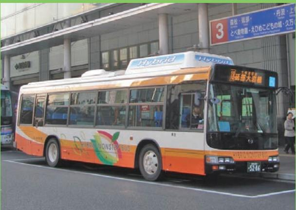
走行中に充電した電池で駆動するモーターを搭載しており、発進や坂道などを登る際にディーゼルエンジンを助けるため、通常より燃料の消費量を10~15%削減できます。温室効果ガスの二酸化炭素排出量も従来より9~17%削減できます。
