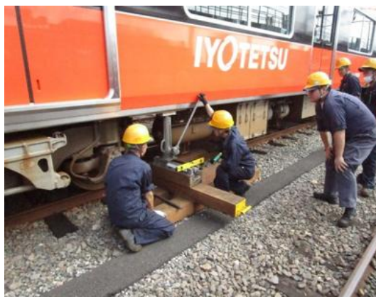
【車両】7000系車両の脱線復旧訓練
