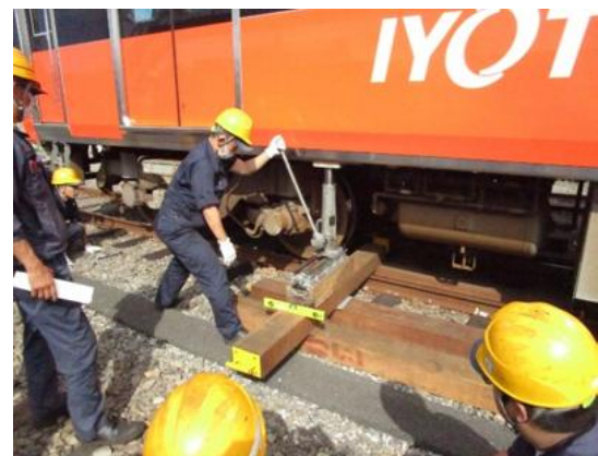
【車両】7000系車両の脱線復旧訓練
