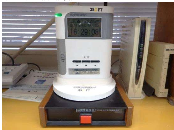
緊急地震速報受信装置
