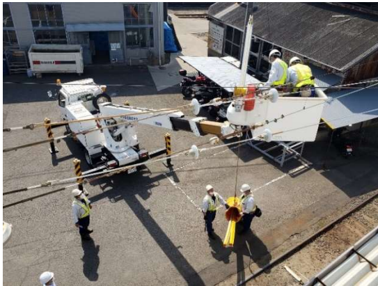
電路係員による高所作業車等取扱い訓練
