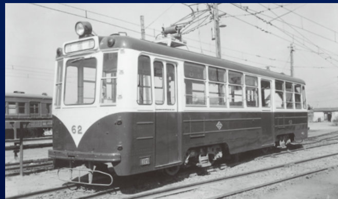
昭和35年に登場した62号車 前面窓のうち中央窓が大きく側面にリブがあるのが特徴。
