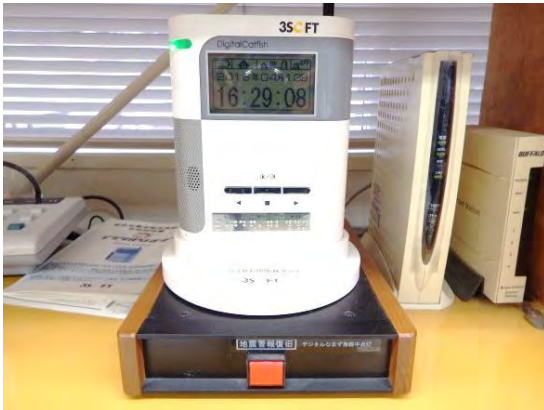
緊急地震速報受信装置
